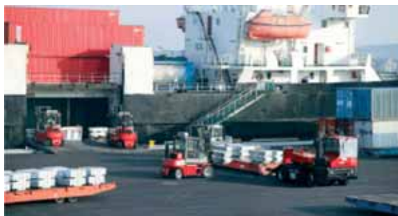
شکل ۳- یک تراکتور بندری در حال یدک کشیدن یک شاسی
