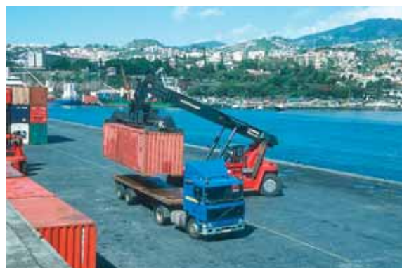
شکل ۲- ریچ‌استکر در حال بارگیری کانتینر
