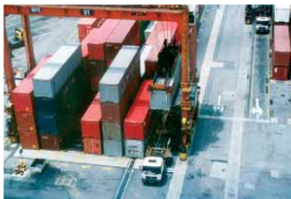
شکل ۱- جرثقیل دروازه‌ای چرخ لاستیکی در حال بارگیری کانتینر
